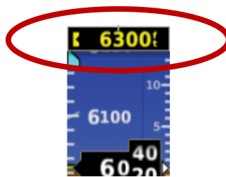
Figure 4 : Alerte visuelle si déviation de l'altitude cible
